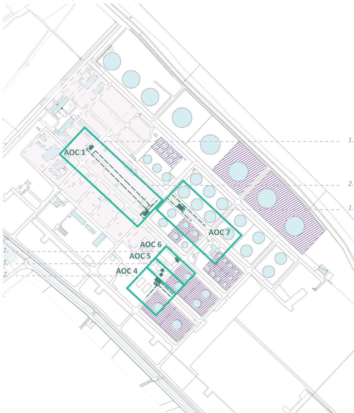
Fig. 28 : schéma du projet d'assainissement du site de l'ancienne raffinerie de Collombey-Muraz
