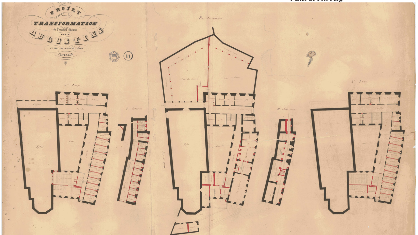
164 Plans de transformation (premier étage, rez, deuxième étage) du couvent en prison © Archives de l'Etat de Fribourg
