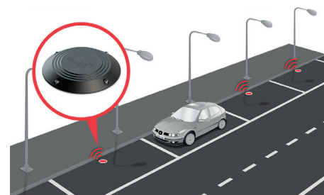
Fig. 34 : Schéma des systèmes d'aide à la recherche de parking
