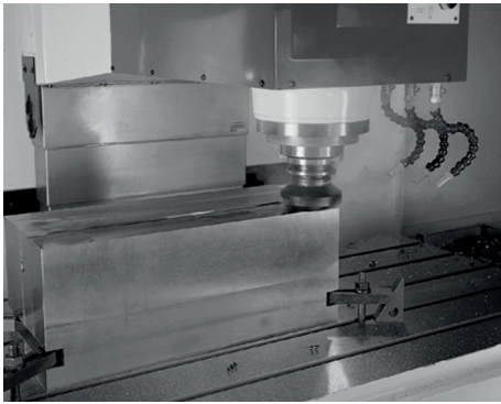
Fig. 12 : Processus d'usinage avec une fraiseuse verticale
