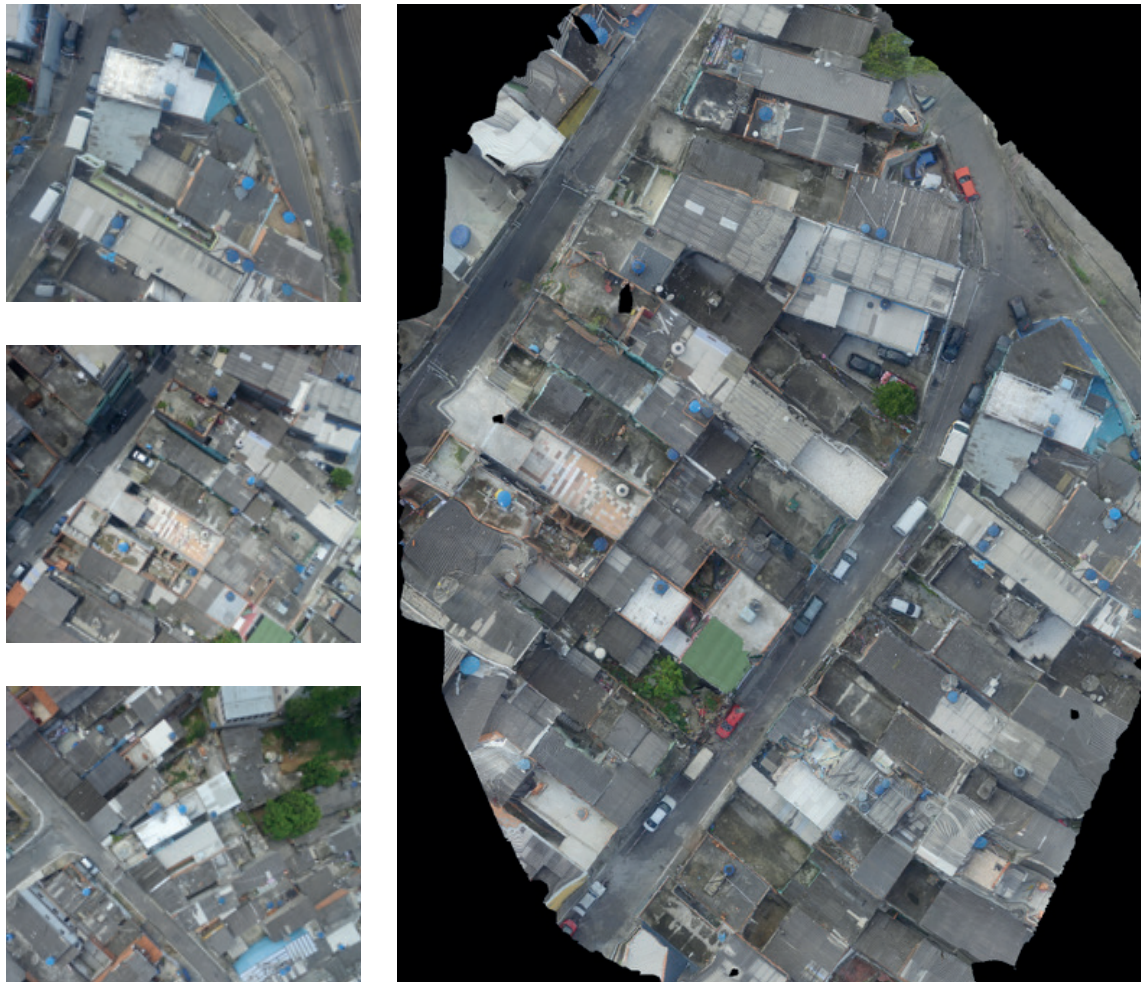
Fig. 1: Exemplos de imagens adquiridas por drone e composição do ortomosaico. Fonte: UNINOVE; elaboração dos autores.
