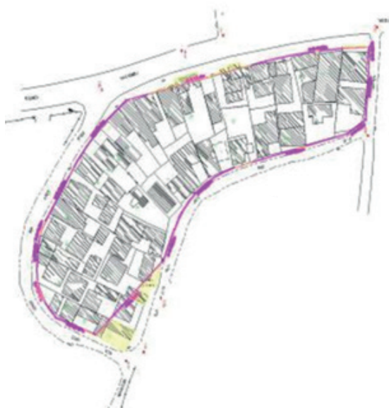
Fig 5: Detalhes da restituição topográfica por quadra/lote (proposta fundiária). Fonte: Prefeitura de Várzea Paulista; elaboração do autor.
