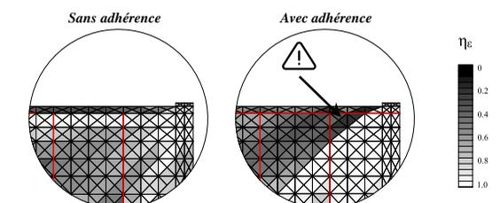
L'outil développé aura un grand intérêt pour des futures études à propos du comportement d'éléments de structures présentant des armatures dans des conditions sévères de fissuration.
