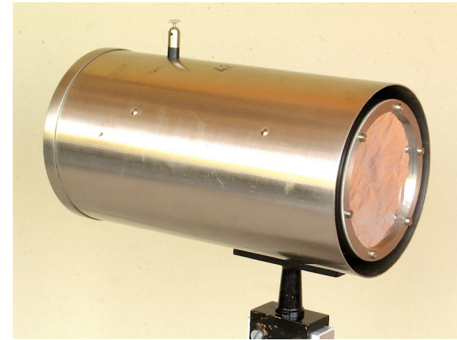
Chambre d'ionisation (Beaudouin; \varnothing 12 cm)
