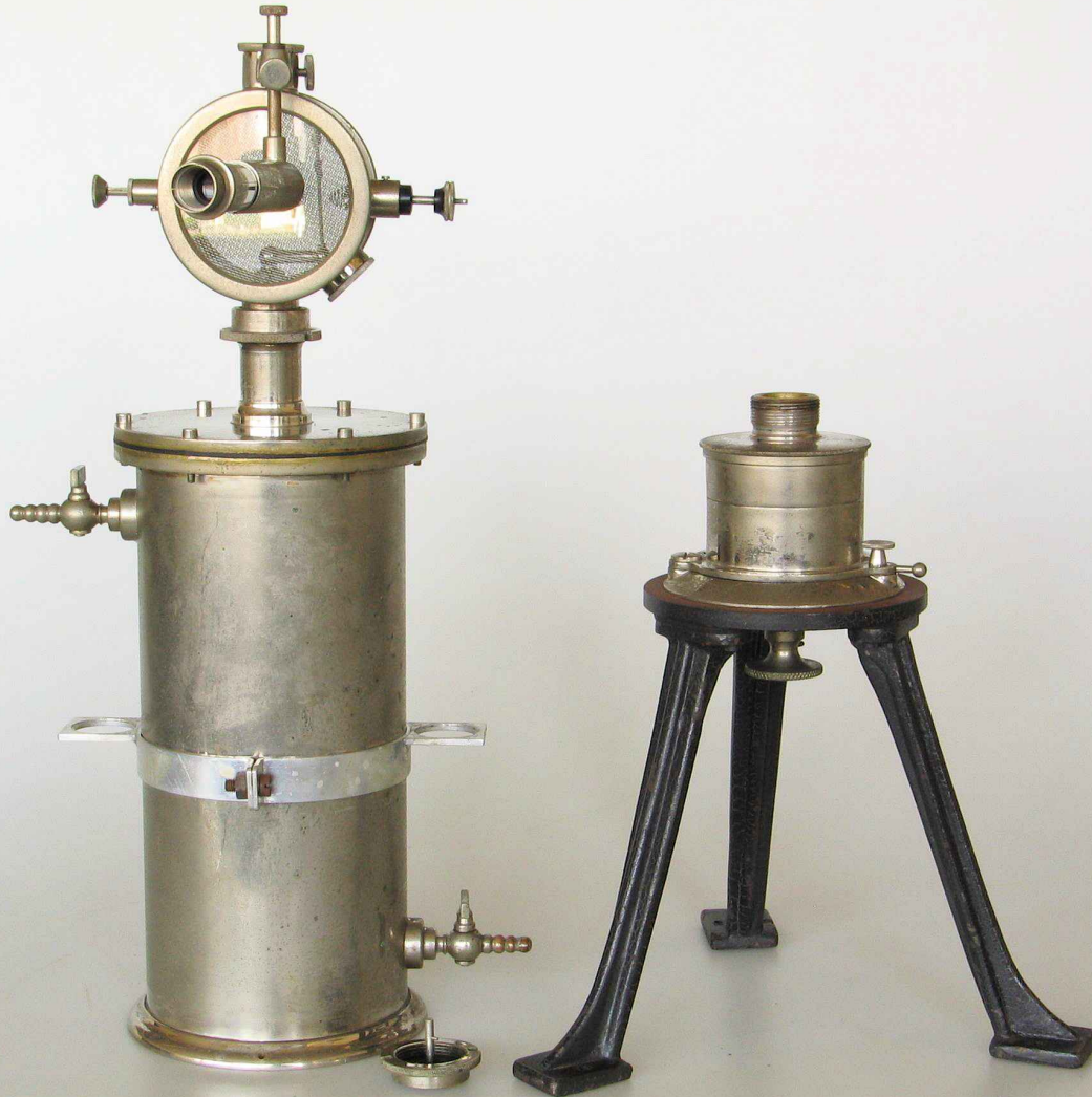
Électroscope P. Curie et chambres d'ionisation de Chéneveau et Laborde :
