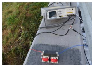
L'appareillage consiste en une sonde en ferrite reliée à un RLC mètre.
