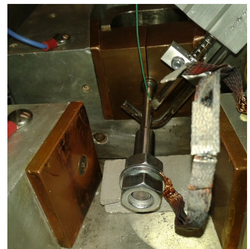
Figure 22. Test de chauffe avec une liaison en cuivre sur Gleeble® 1500
