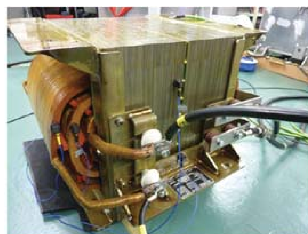
IKERLAN: 400kW, 1kHz
