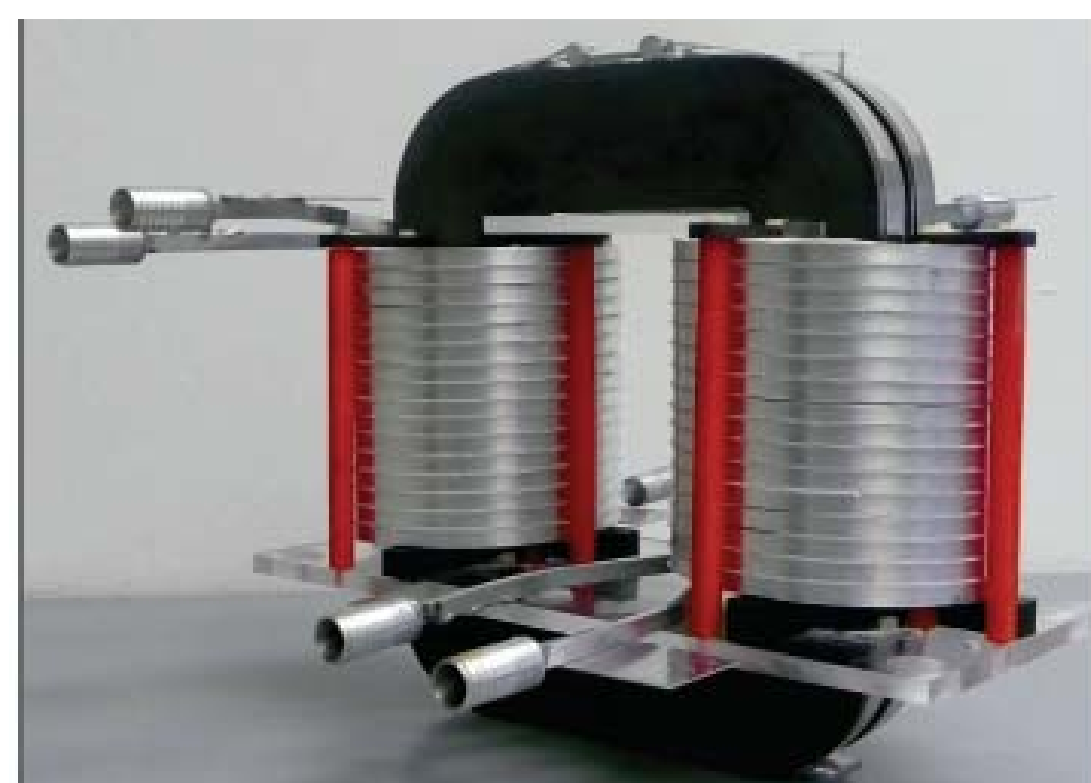
FAU-EN: 450kW, 5.6kHz
