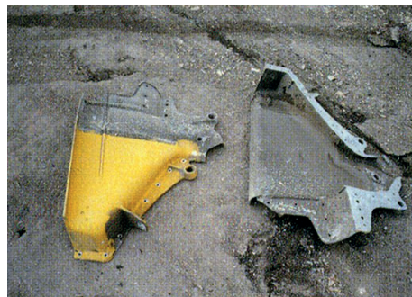
fig. 3.51 Séparation de la «bielle-gargouille», 1993
