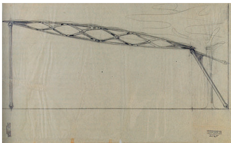
fig. 3.3 Variante de structure avec accrochage du quai d'Orsay, 1954, deux accroches au mur
