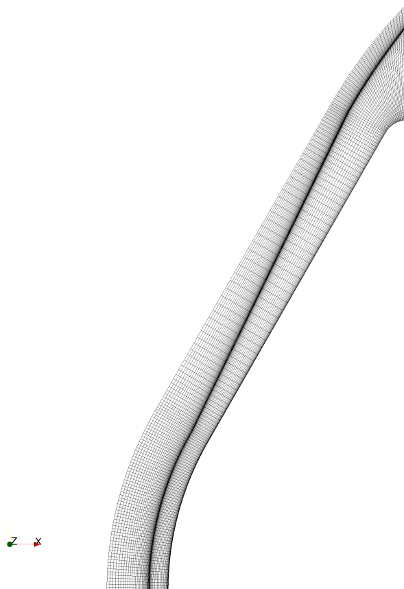
Figure 9: Maillage Eilmer3 avec épaulement
