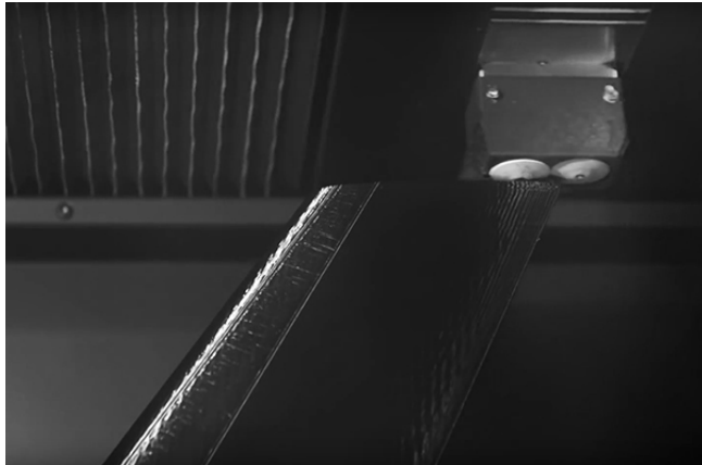
Aile de drone en cours d'impression 3D 7
