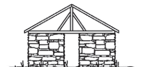
ill. 82. Façades aval de tsijières du Val d'Anniviers avec pile ou poinçon pour soutenir le faîte (Anderegg, 2011)
