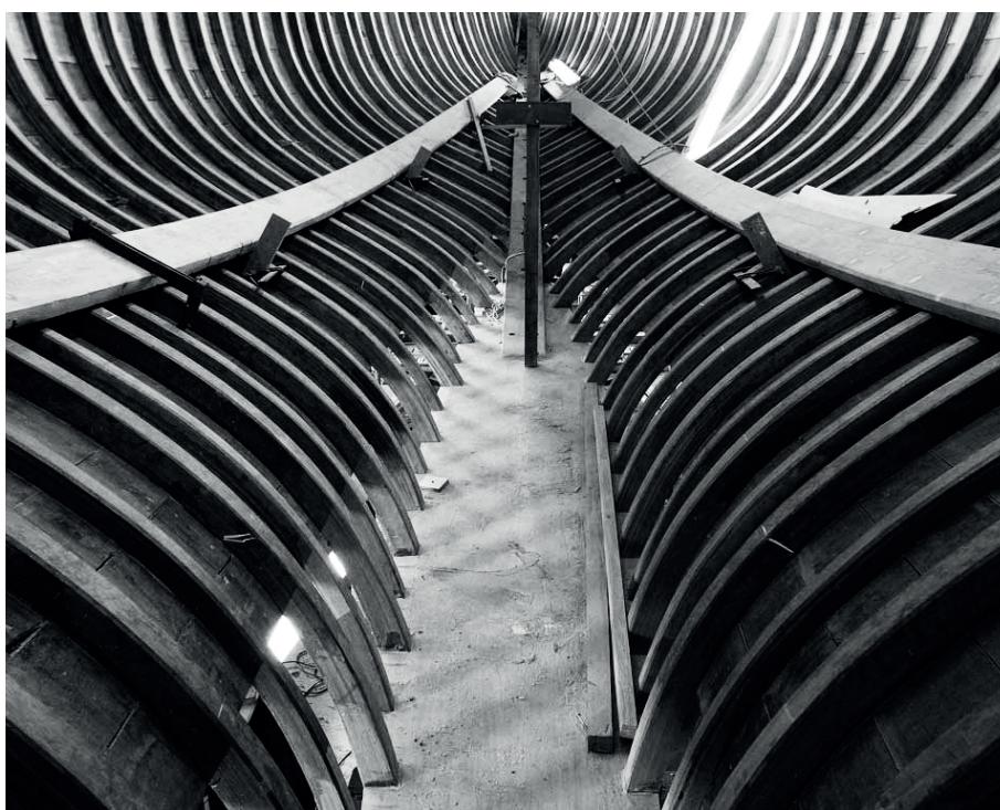
Charpente d'un voilier montrant les membrures et la quille.
