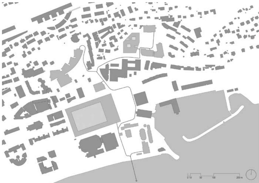
**Figure 7** : Localisation du réseau d'eau du lac utilisé pour le rafraîchissement écologique des bâtiments du quartier, dont Microcity. (source : Bauart d'après indications de Viteos SA)
