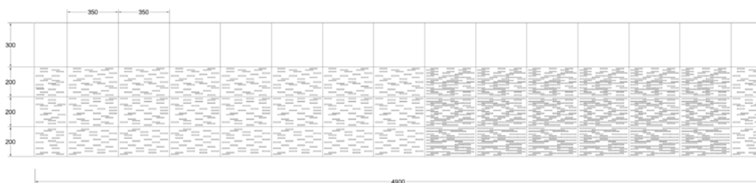
Fig. 88 – disegno del pannello di zinco della navata laterale posta a nord
