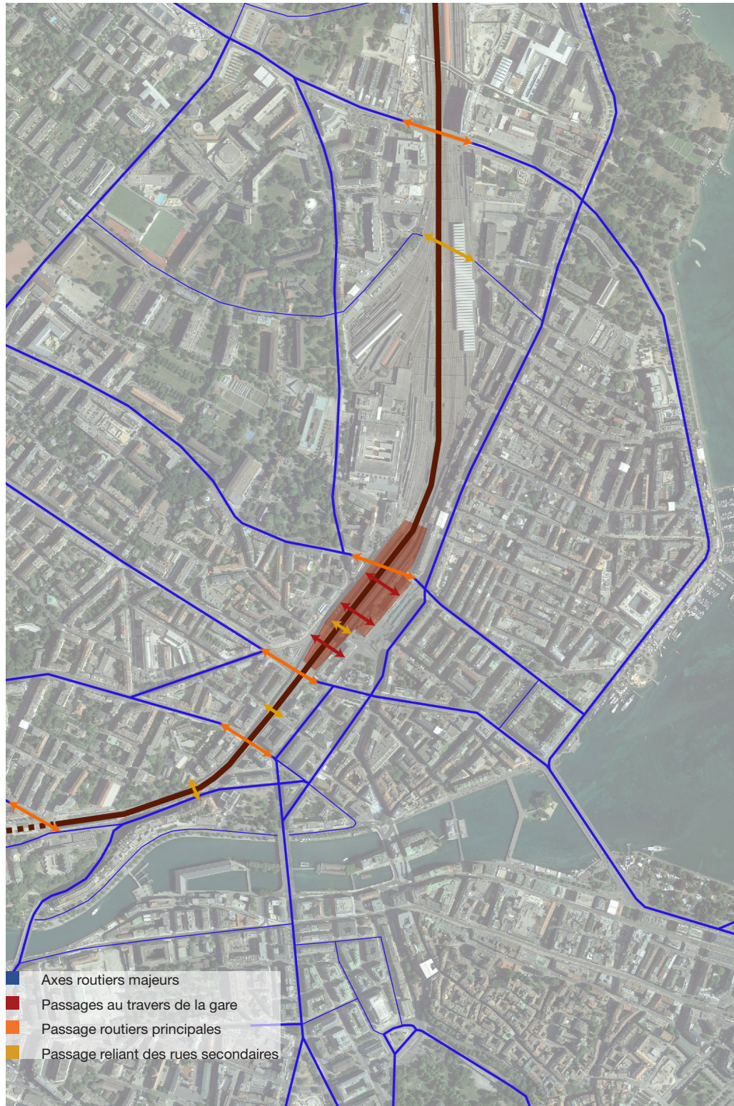
Plan de Genève, situation des passages au travers des infrastructures ferroviaires 27
