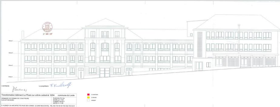
En façade nord, on distingue la fabrique sur la partie gauche, ses fenêtres allant par paire encadrés par le rythme régulier pilastres. Le corps central saillant des parties administratives, surelevées et à droite le bâtiment d'habitation qui partage les planchers en commun avec le reste du bâtiment, ses ouvertures ne le distingue en rien, les énorme toitures à croupe permettent une lecture d'ensemble malgré leurs chevauchements.
