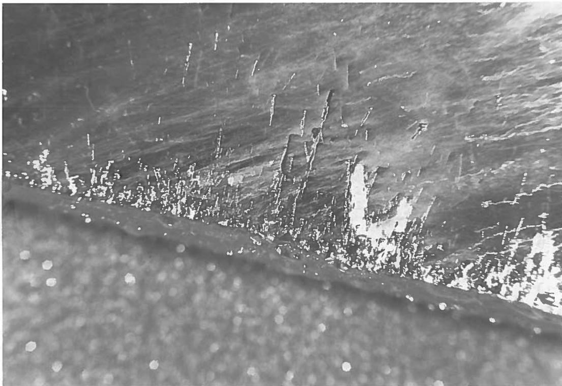
Fig. 8 Au verso du même limiteur, la fusion de la surface est
