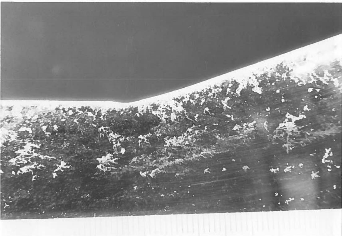
Fig. 4 Traces d'arcages sur les anciens écrans d'antenne. Il n'y a pas de déplacement linéaire des arcs, car les écrans sont perpendiculaires aux lignes de champ.
