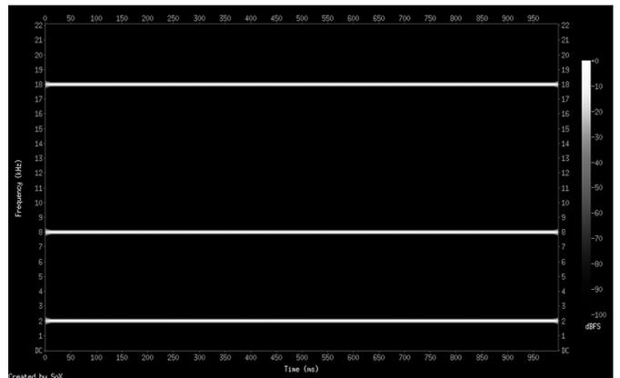
Nous allons effectuer un filtrage passe-bas afin de couper les fréquences dépassant 6 kHz et refaire un spectrogramme pour vérifier le résultat, soit:
