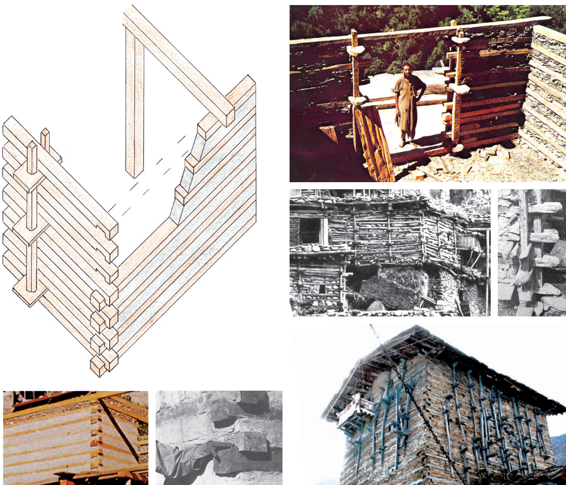
Fig.49 Insertions horizontales rapprochées : a) Axonométrie de la variante avec encastrement aux angles ; Bâtiments avec aiguilles verticales dans la région du Nuristan, Afghanistan (b,c,d, Crédits : b, Jones, c, Wutt, d, Edelberg) et à Kharsali, Etat de l'Uttarakhand, Inde (e, Crédit : Hrish) ; f, g) Version sans aiguilles, mais avec encastrement des insertions aux angles, Kamdesh, Nuristan (Crédits : Edelberg).
