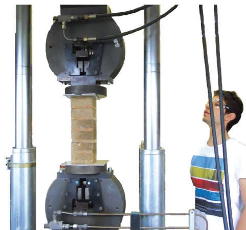
Fig.115 Instrument de charge utilisé pour tester la résistance à la compression des blocs en terre crue.
