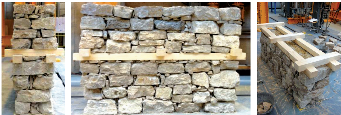
Fig.131 Mur en pierres sèches comprenant une insertion horizontale en forme d'échelle dont le comportement sismique a été analysé à la Haute Ecole d'Ingénierie et d'Architecture de Fribourg, au travers d'essais statique-cycliques (Crédits : Sturny et Lüchinger) : vues transversale (a), latérale (b) et depuis le haut (c).
