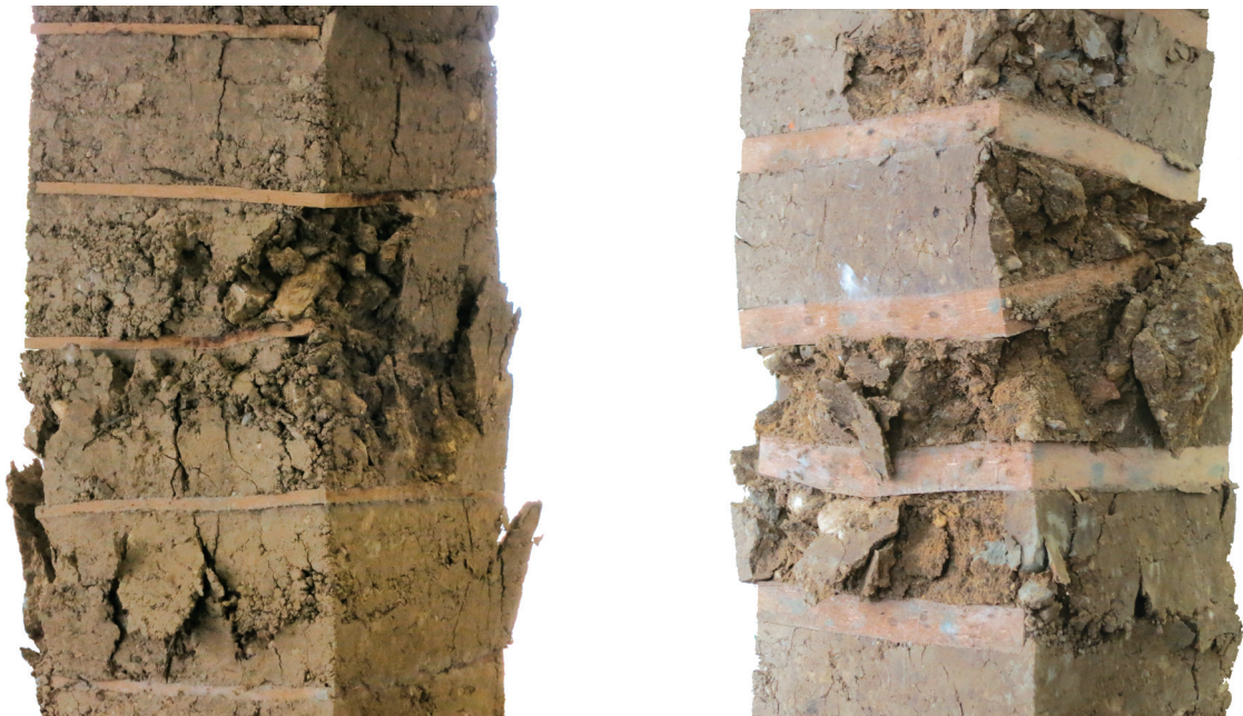
Fig.118 Déformation à la rupture très importante : a) Bloc avec insertions souples ; b) Bloc avec insertions rigides (Crédits : Lehmann, Moccia et Reinle).
