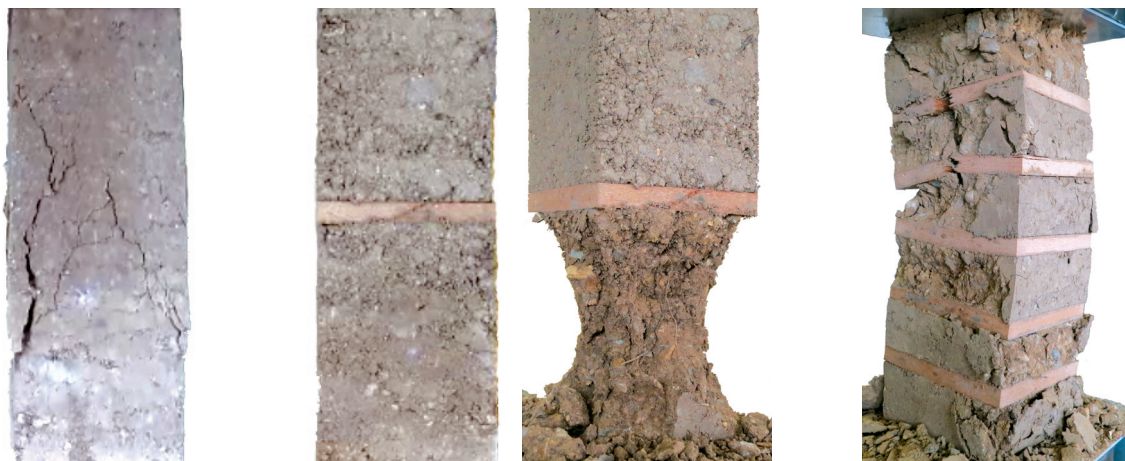
Fig.117 Comportement d'autres échantillons : a) Rupture fragile du bloc sans insertions horizontales ; Bloc avec une seule insertion, épaisse et pleine, avant sa mise en compression (b) et après (c) ; d) Rupture en traction des insertions creuses, due à la pression latérale exercée par la terre (Crédits : Lehmann, Moccia et Reinle).
