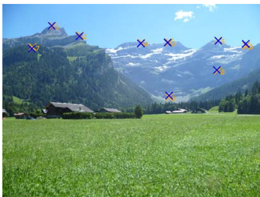
FIGURE 4.7: Projection des GCPs du système objet dans l'image
