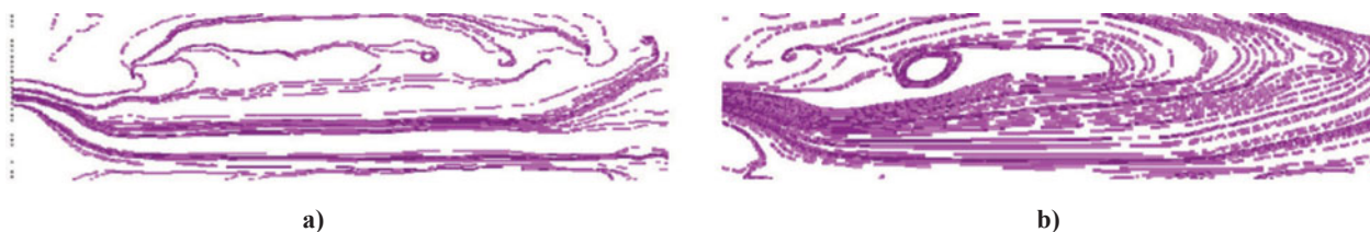
Figure 8 : Champ d'écoulement dans un réservoir à entrée et sortie symétrique. Conditions d'essais L = 6\text{ m} , B = 1\text{ m} , h = 0.2\text{ m} , Q = 7\text{ l/s} , L/B = 6 , Fr = 0.1 , Re = 28000 . a) Fond rugueux k_s = 2.8\text{ mm} , b) Fond lisse k_s = 0.1\text{ mm} .
