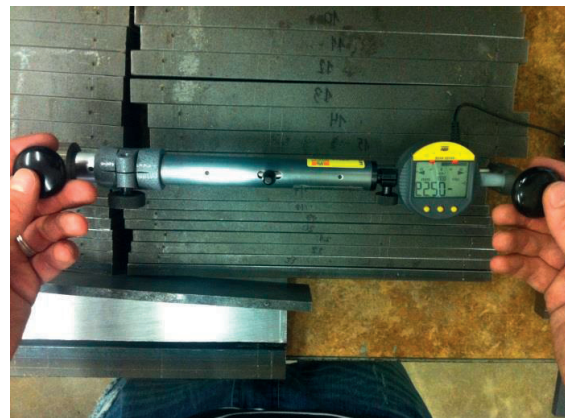
(b) Mesure des distances au déformètre
