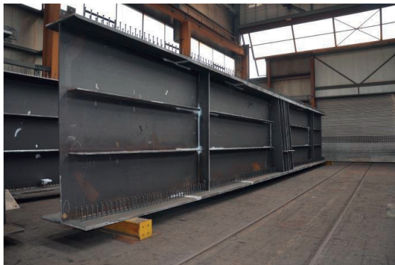
a) tronçon sur appuis (T10), L = 20 m
