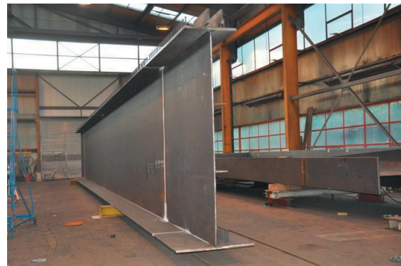
b) tronçon en travée (T11), L = 28 m
