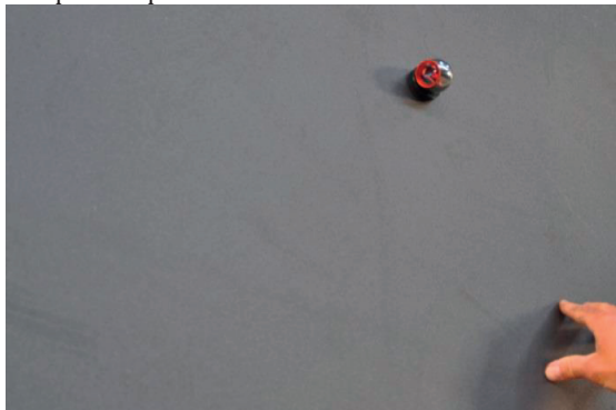
(c) étape 5, mesure de l'âme (partie plane et verticale). Le réflecteur est ajusté avec un adaptateur plat.
