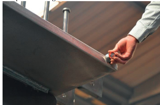
(d) étape 6, mesure de l'arête supérieure de la semelle supérieure. Le réflecteur est ajusté avec un adaptateur d'angle.
