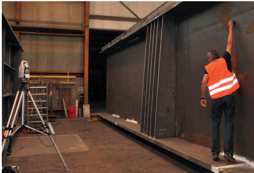
Figure 4.4 Illustration de mesure par Laser Tracker sur la poutre T10.
