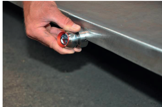
(b) étape 4, mesure de l'arête inférieure de la semelle inférieure. Le réflecteur est ajusté avec un adaptateur d'angle.
