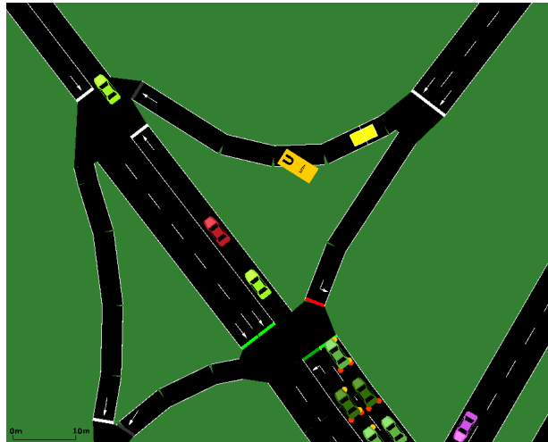
FIGURE 4.5 – Rerouter. Objet permettant de définir une nouvelle destination pour les véhicules.
