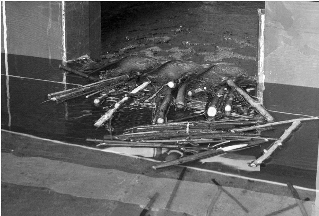
Abb. 5: Verklaustes Klaviertastenwehr im physikalischen Modell, Sicht vom Oberwasser (Foto LCH)
