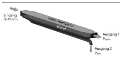
Bild 6: Fluidphasen in der numerischen Simulation mit ANSYS CFX
