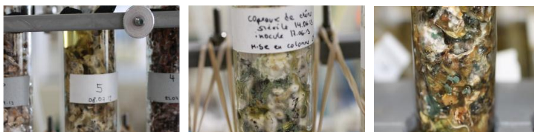
c) Présence d'autres champignons et colmatage de la colonne
