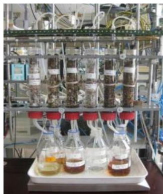
a) Système de colonnes avec eau en recirculation
