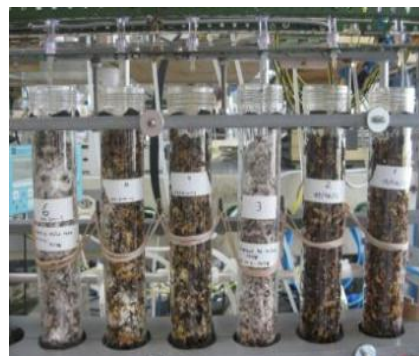
b) Colonnes avec les différents supports et T. versicolor
