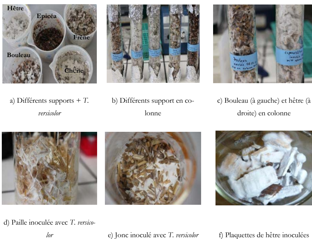
Figure 9: Croissance de Trametes versicolor sur différents supports
