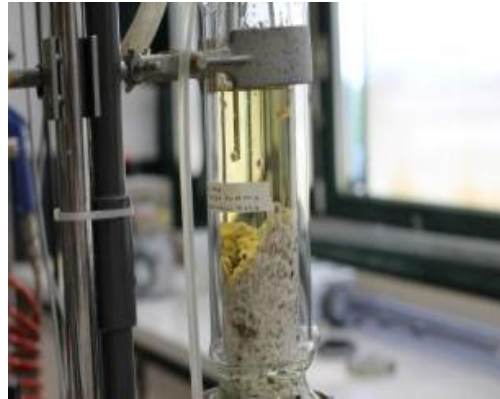
Figure 7: Colonne avec fermeture de vanne, contact eau-support prolongé
