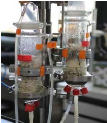
Figure 8: Nouveau système de colonnes à tester, recirculation permettant un meilleur contact eau-support
