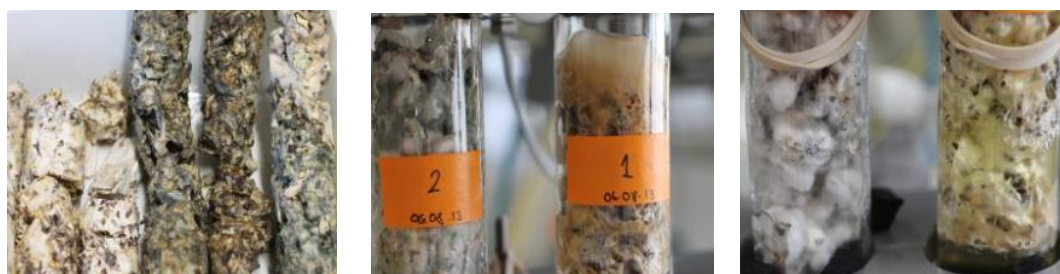
e) Colmatage des colonnes, présence d'un champignon vert (à gauche), présence d'un biofilm en surface (à droite)
