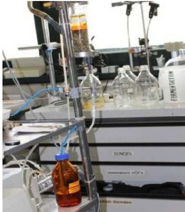
Figure 6: système de colonne avec fermeture de vanne pour éviter la filtration immédiate (saturation)
