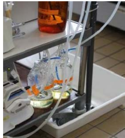
Figure 8: Nouveau système de colonnes à tester, recirculation permettant un meilleur contact eau-support
