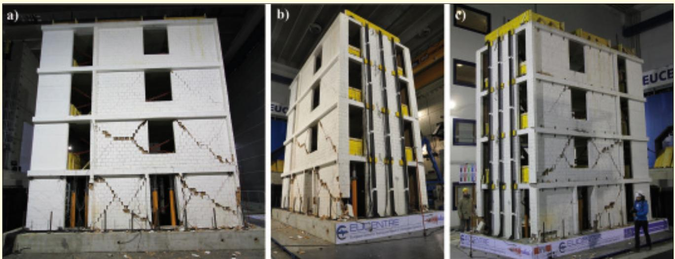
Bild 8. Zustand des Gebäudes nach dem letzten Versuchsdurchlauf.
