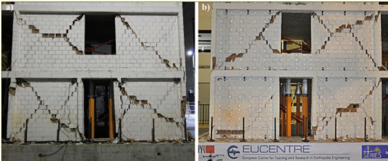
Bild 9. Die unteren beiden Etagen der Mauerwerkswände, welche parallel zu ihrer Ebene beansprucht wurden, nach dem letzten Versuchsdurchlauf.
