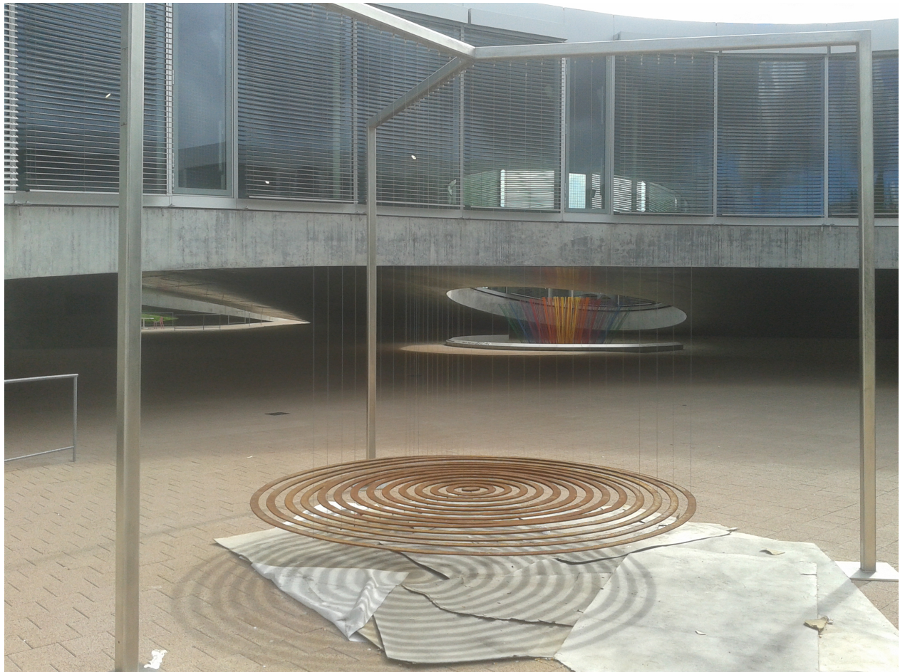
Figure 1 : Le phénomène de corrosion s'observe sur cette sculpture présente sur le campus de l'EPFL. Les anneaux en acier se corrodent et la surface se couvre de rouille. Les poteaux qui soutiennent la sculpture sont en acier galvanisé et ne présente aucun signe de corrosion pour la même durée d'exposition.
