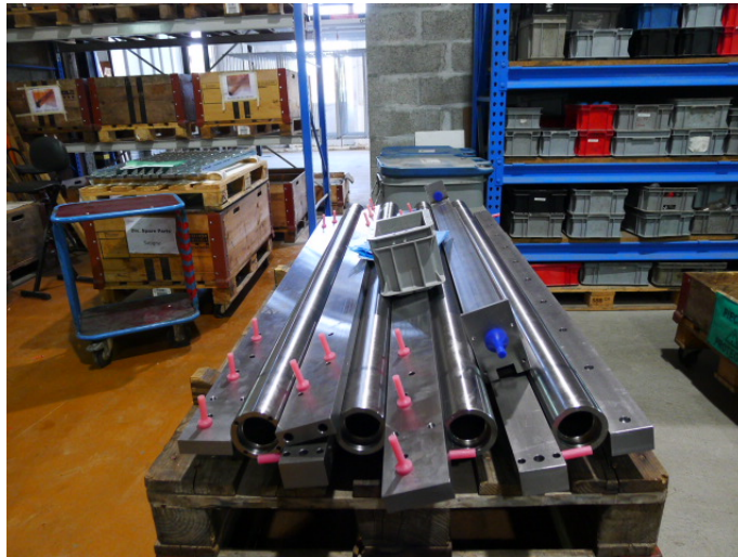
Figure 19 : Préparation des pièces creuses : des bouchons sont placés afin de contrôler l'infiltration de fluide dans les parties creuses.
