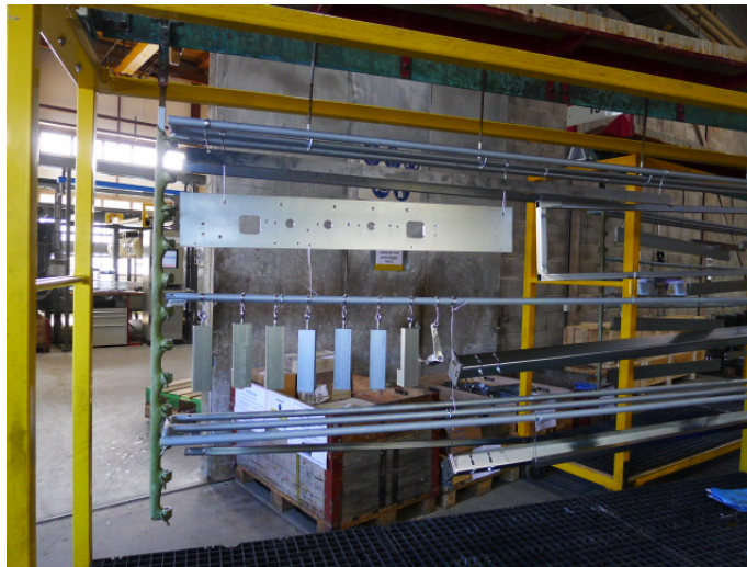
Figure 20 : Mise en place manuelle des pièces à traiter sur les bâtis de trempage avant la mise en place dans la ligne de traitement automatisée.
