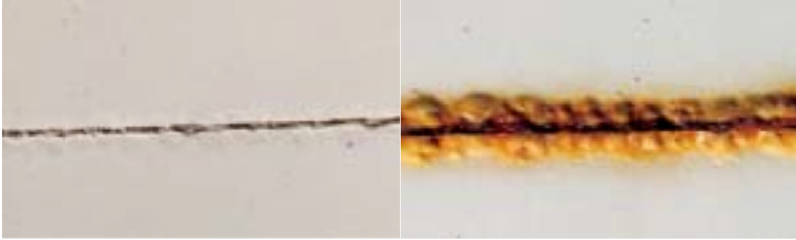
Figure 17 : Développement de la corrosion à un joint de peinture sur une surface galvanisée (gauche) et non galvanisée (droite). Source [IZA 00].
