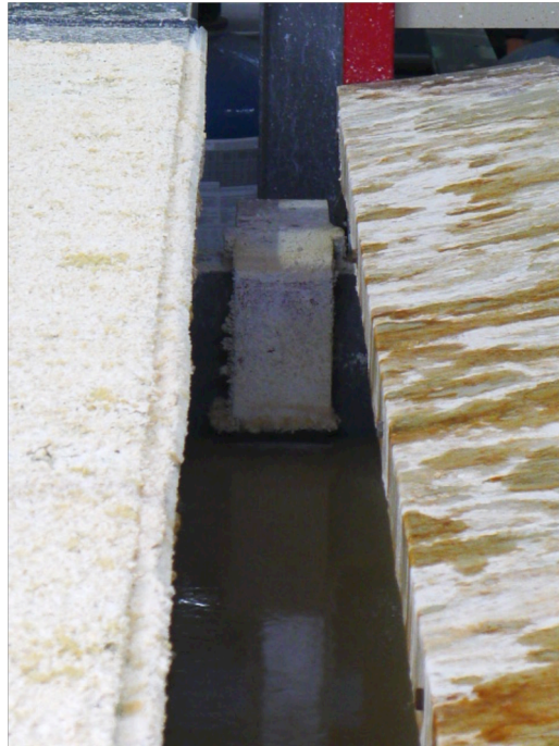
Figure 22 : Anode de zinc au contact de la solution électrolytique basique.
