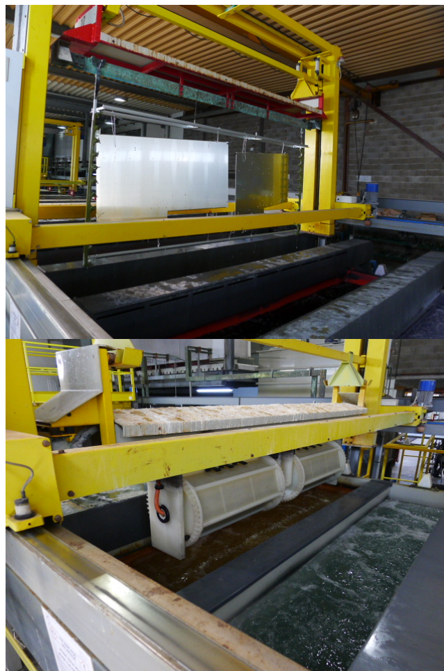
Figure 21 : Traitement automatisé des pièces et passage dans les bains successifs. Gauche : Pièces de type plaque. Droite : Utilisation de tambours pour les pièces de petites tailles (par exemple boulon).
