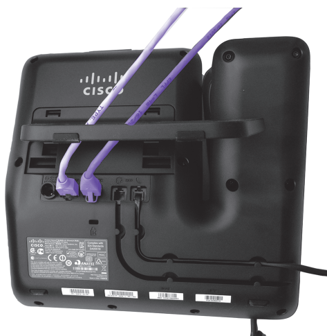
connexion via EPNET et raccordement à l'ordinateur à l'arrière du téléphone VoIP
