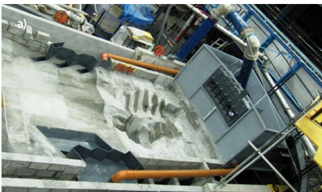
Bild 2: Kariba-Talsperre am LCH: a) Übersicht physikalisches Modell mit derzeitigem Kolkloch; b) Fokus auf die optimierte Kolkgeometrie
