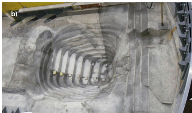
Bild 2: Kariba-Talsperre am LCH: a) Übersicht physikalisches Modell mit derzeitigem Kolkloch; b) Fokus auf die optimierte Kolkgeometrie
