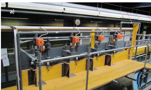
Bild 4: Physikalisches Modell mit a) Zentrale Veytaux 1 und b) Ein- und Auslaufbauwerk in den Genfersee
