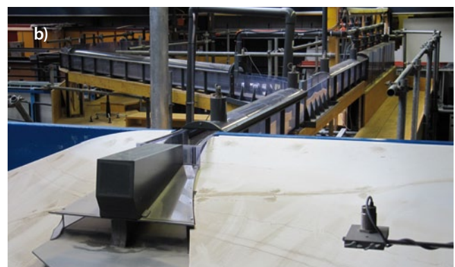
Bild 4: Physikalisches Modell mit a) Zentrale Veytaux 1 und b) Ein- und Auslaufbauwerk in den Genfersee
