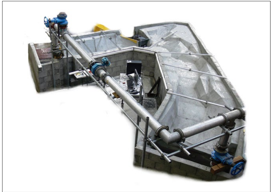
Bild 5: Physikalisches Modell des Guayllabamba-Flusses mit Einlaufbauwerk zum Geschiebe- und Hochwasserumleitstollen
