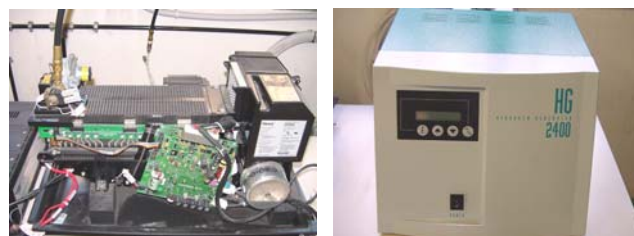
Fig. 12 Cella a combustibile Ballard Nexa 1200W ed elettrolizzatore Claind HG2000
