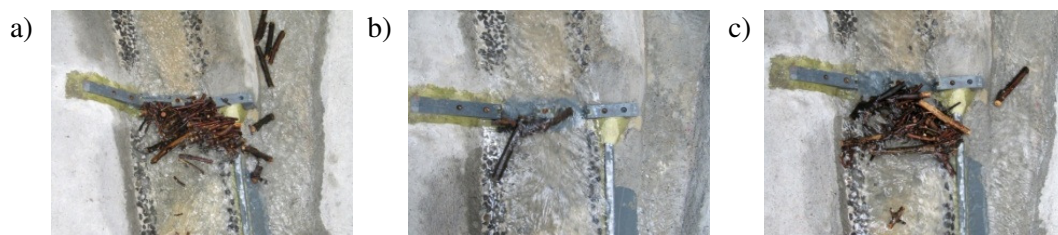
Fig. 17 Situation finale des avec bois flottants: a) C6Q1_1; b) C8Q1_3; c) C8Q1_2
