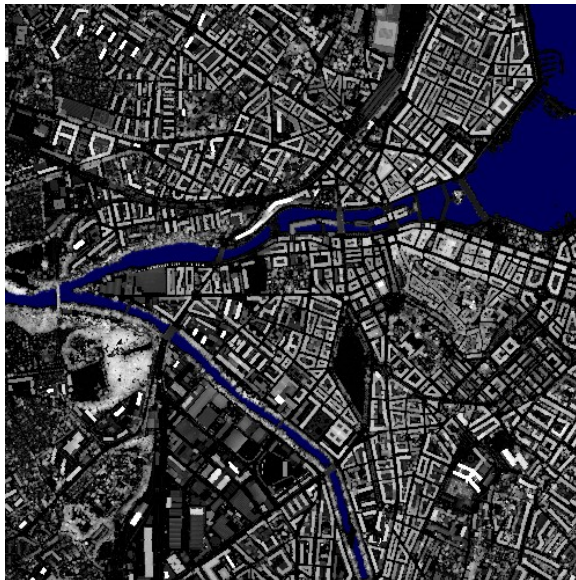
Figure 21: classification de l'eau (MNH=0 et Intensité=0)
