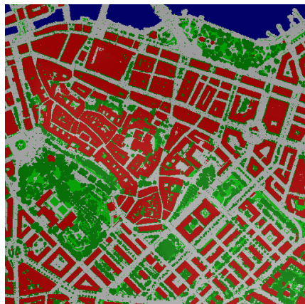
Figure 27: classification des sols imperméables en gris (sol avec intensité >30) et des sols perméables en vert clair (intensité ≤30)
