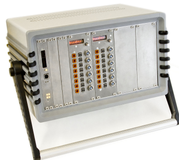
Figure 6.16 – Unité de contrôle utilisée lors des tests en fonctionnement générateur
