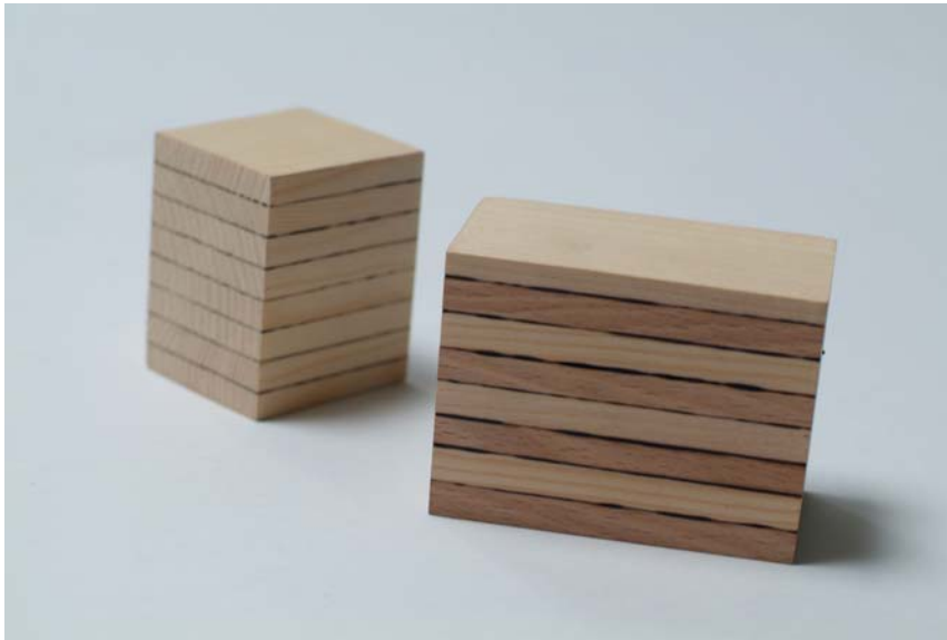
Abbildung 4: Verschweisste mehrschichtige Holzkörper aus Fichten- (Hintergrund) bzw. Buchen- und Fichtenlamellen (Vordergrund)
