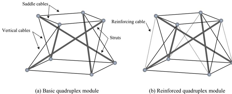
**Figure 2.** Quadruplex module
