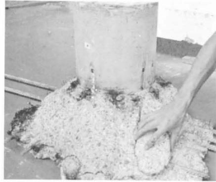
b) Durchstanzkegel mit losen Betonstücken
