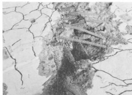
b) Bereich mit starker Schiebung ( $x = 150$  mm,  $y = -125$  mm), loser Beton ist entfernt worden
