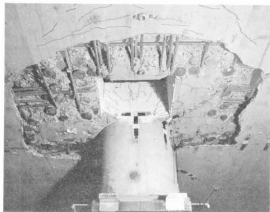
c) Bruchbereich Plattenunterseite; Ankerplättchen der Bügel sind sichtbar infolge Betonabplatzungen
