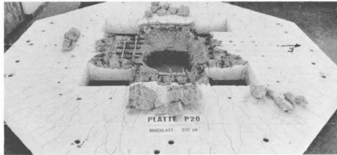
d) grössere lose Betonstücke sind aus dem Bruchbereich entfernt und auf die Platte gelegt worden
