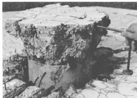
c) Durchstanzkegel mit einem Bügel des innersten Ringes in Soll-Lage
