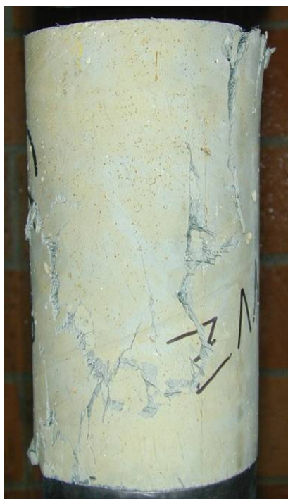
Abbildung 10: Bruchbild eines 11-cm-Zylinders
