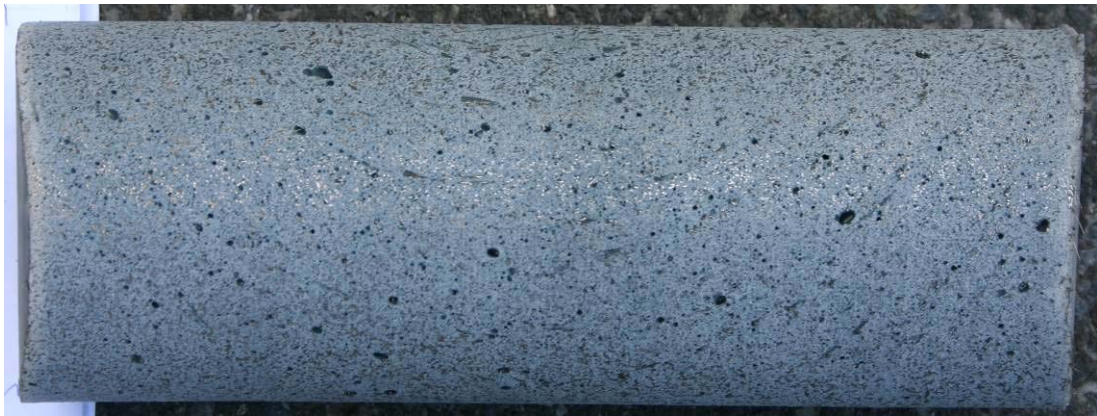
Abbildung 3: Ansicht quer zur Längsachse (Blick von der Seite). Eine Schichtung in Form von gegen oben geöffneten Kreisbögen ist zu erkennen
