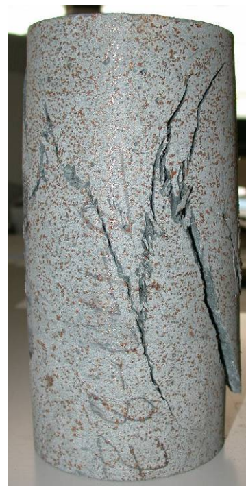
Abbildung 11: Bruchbild eines 8-cm-Zylinders
