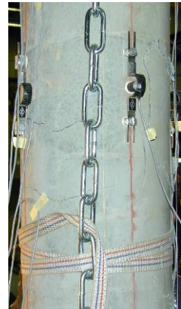
Abbildung 101: Das plastische Gelenk aufgenommen aus nordöstlicher (oben) und südwestlicher Richtung
