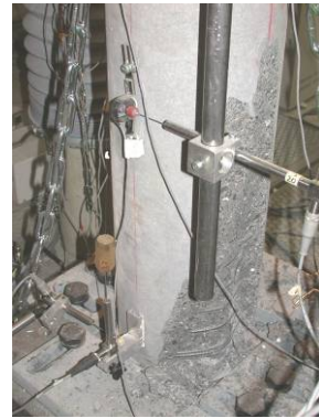
Abbildung 132: Abplatzungen auf der Druckseite, in der Stützenmitte (oben) und am Fuss
