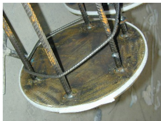
Abbildung 26: Fussplatte mit aufgeschweissten Bewehrungsstäben. (Bei diesem Beispiel handelt es sich nicht um eine der Stützen, die für die Versuche benutzt werden)
