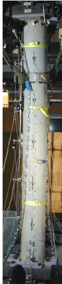
Abbildung 108: Der Bruch findet am Fuss der Stütze statt
