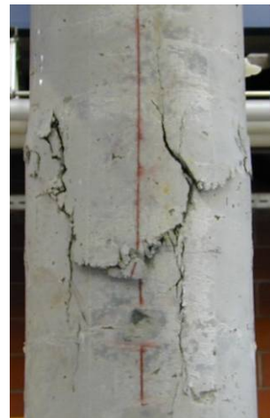
Abbildung 83: Das plastische Gelenk von Norden (oben) und von Osten
