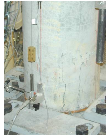
Abbildung 124: Die Bruchstelle am Stützenfuss, von Norden (oben) und von Süden
