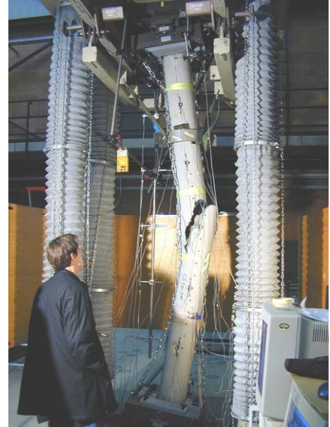
Abbildung 33: Nach dem Bruch (hier Stütze S1-1) ist die Wichtigkeit der Sicherungssysteme gut zu erkennen
