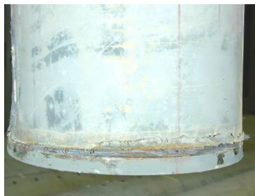
Abbildung 116: Die Bruchstelle am Stützenfuss von Norden (oben), Osten (Mitte) und von Westen
