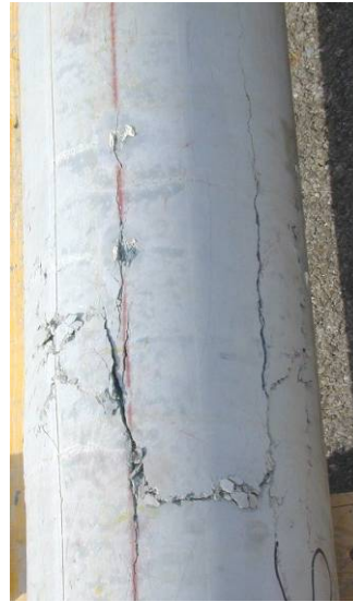
Abbildung 90: Plastisches Gelenk aufgenommen von der Druckseite
