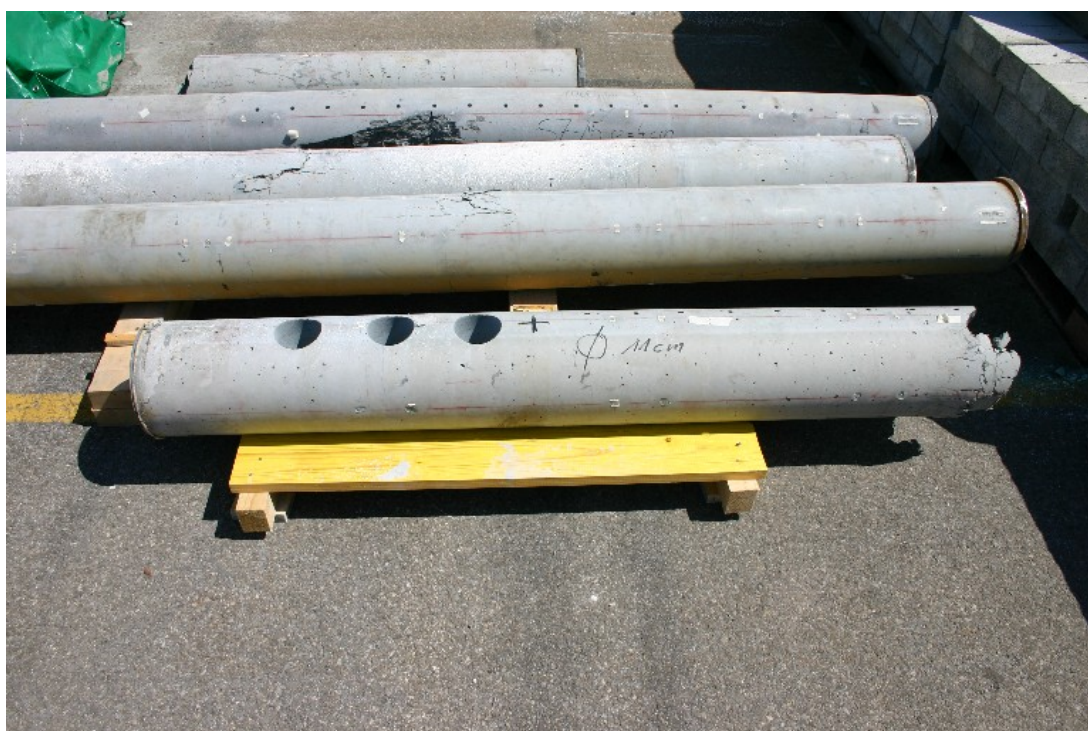
Abbildung 1: Die Bohrkern werden in der weitgehend unbeschadeten Zone zwischen Krafteinleitungs- und Bruchzone entnommen
