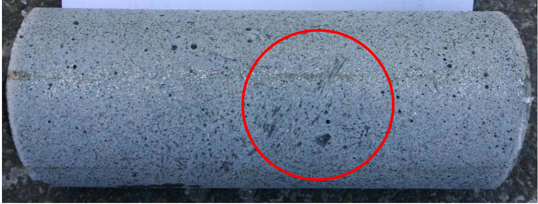
Abbildung 2: Ansicht in Richtung der Stützen-Längsachse (Blick von unten). In der Mitte sind zahlreiche Fasern zu erkennen, die weitgehend in der Ebene der Schnittfläche liegen
