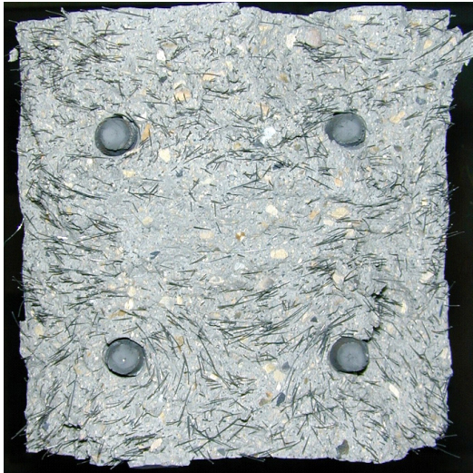
Bild 12: Bruchfläche des vollständig getrennten Versuchskörpers
