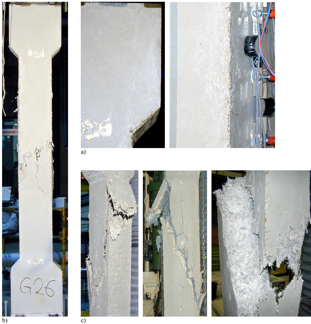
Bild 78a-c: Entwicklung des Bruches (a), Versuchskörper nach der Belastung (b) und Details der Bruchzone (c)
