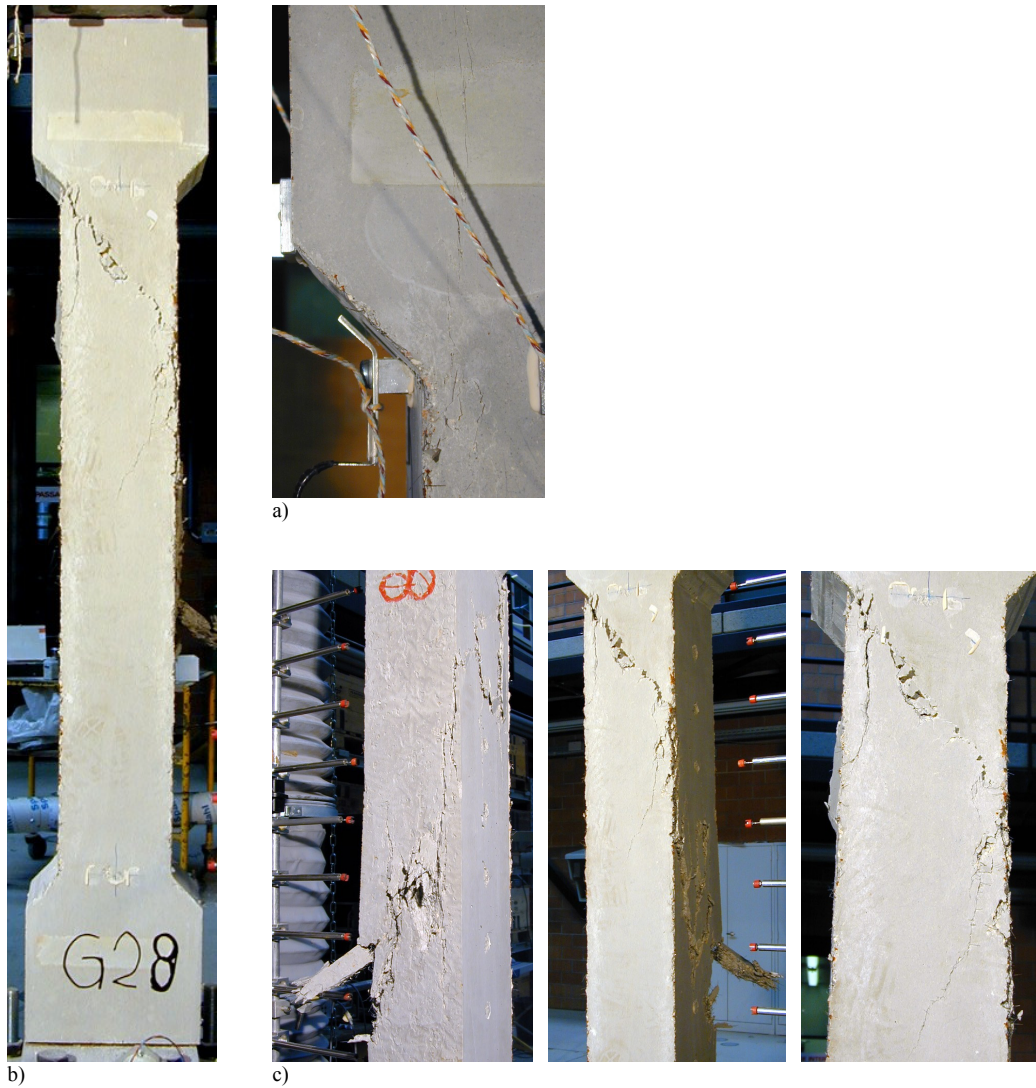
Bild 84a-c: Entwicklung des Bruches (a), Versuchskörper nach der Belastung (b) und Details der Bruchzone (c)
