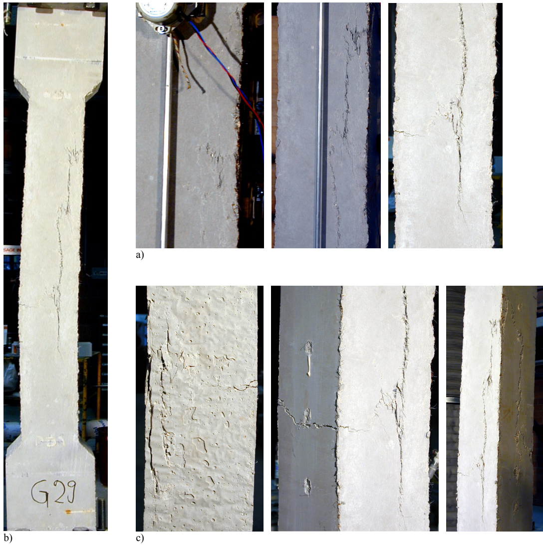
Bild 66a-c: Entwicklung des Bruches (a), Versuchskörper nach der Belastung (b) und Details der Bruchzone (c)
