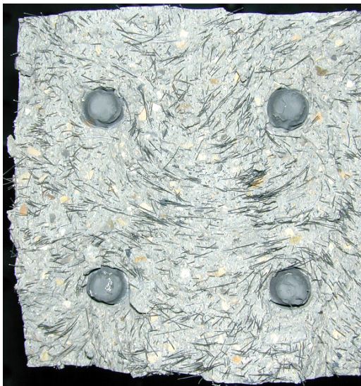
Bild 17: Bruchfläche des vollständig getrennten Versuchskörpers
