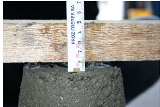
b) Slump test
