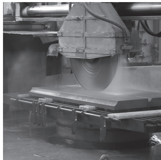
Sciage (fraisage) Découpe selon deux plans Châssis avec scie circulaire diamantée Profondeur maximale de découpe 50 cm
