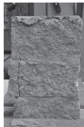
Fig. III.18-19. Essai expérimental sur une maçonnerie en gneiss. À gauche, le basculement du mur entier et, à droite, la rupture par compression d'un échantillon [Khaldoun, E. M. 2010]
