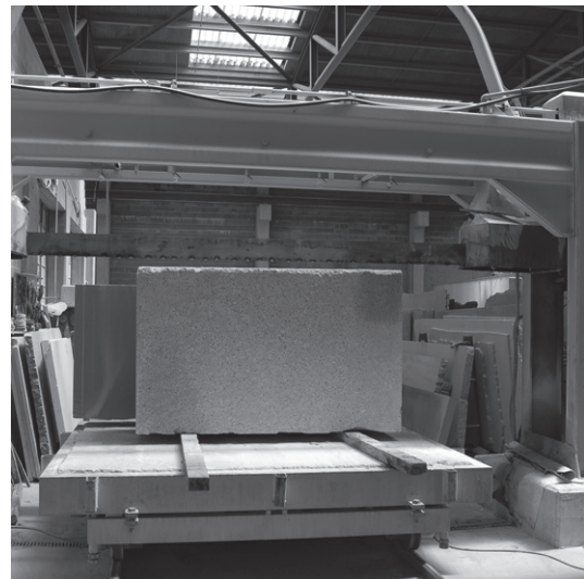
Sciage Découpe selon un plan Châssis monolame Hauteur maximale du bloc 180 cm
