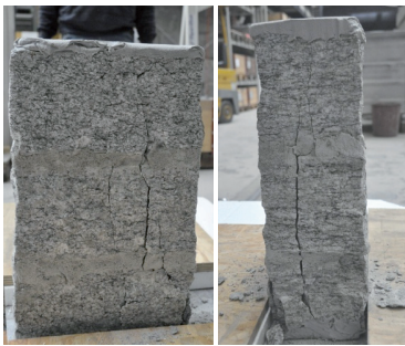
Figure 9 : Rupture du muret 1 en compression.
