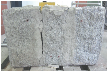
Figure 12 : Rupture en cisaillement du premier muret en gneiss.
