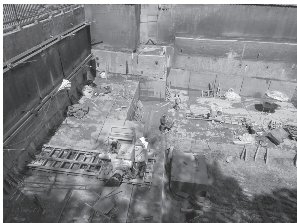
Fig. II.34-35. Exploitation de la carrière urbaine à la haveuse et déplacement des blocs extraits
