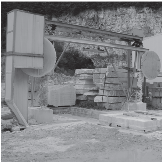
Découpe au fil diamanté Découpe selon un plan Châssis avec fil diamanté Hauteur maximale du bloc 250 cm
