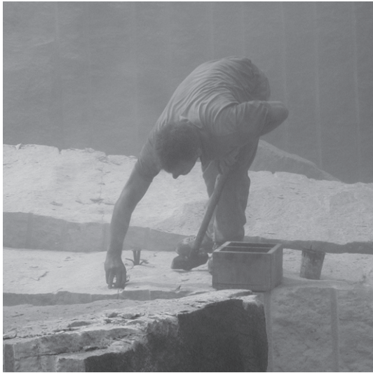
Découpe manuelle Cassure selon plans de clivage Coins écarteurs et masse ou écarteurs hydrauliques Dimensions selon la taille du bloc
