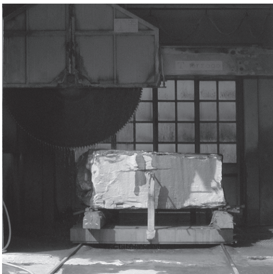
Sciage (fraisage) Découpe selon un plan Châssis avec scie circulaire diamantée Profondeur maximale de découpe 130 cm
