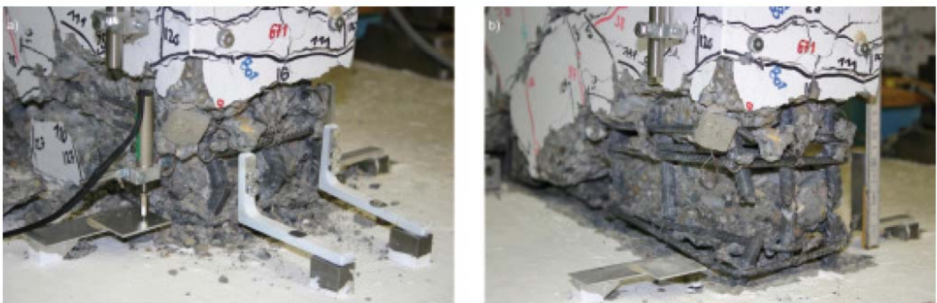
Bild 6. Flansche einer U-förmigen Wand getestet unter quasi-statischer Belastung [BDP08]: Ausgeknickte Endbewehrungsstäbe (a), die nach Lastumkehr rissen (b).
