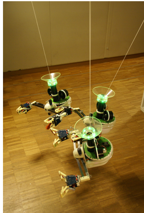
Figure 6.11 Trois handbots assemblés et suspendus par leur câble.
