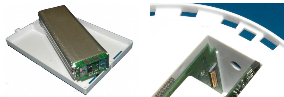
Figure 4.18 L'intérieur du pack batterie et les contacts à l'intérieur de la base
