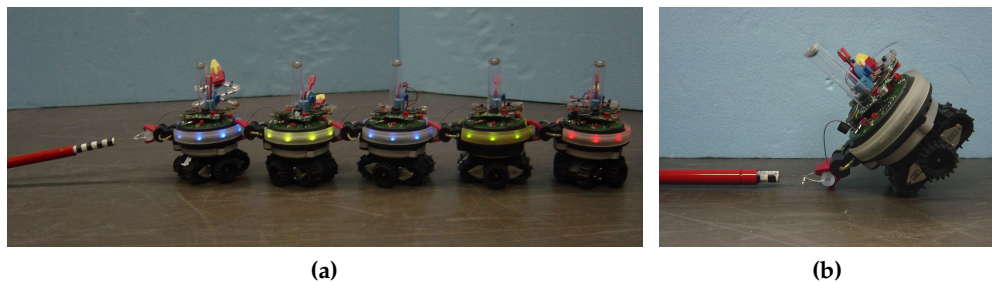
Figure 6.1 (a) 5 s-bots tirent en chaîne sur un dynamomètre. (b) un s-bot tire sur le même dynamomètre.
