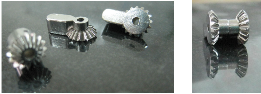
Figure 4.37 Les pièces du système d'accrochage fabriquées en MIM
