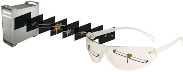
Fig. 2: Les graphismes d'AR sont générés puis encodés sous forme de flux vidéo par l'unité de calcul. Le flux vidéo est ensuite envoyé à travers le canal de communication vers l'utilisateur puis affiché sur des lunettes semi-transparentes dans cet exemple.
