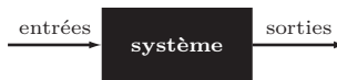
Fig. 10: Un système est représenté sous forme de bloc. Les entrées modifient le comportement d'un système dynamique. Les sorties reflètent ces modifications.
