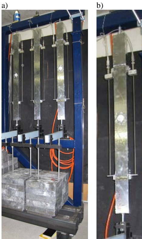
Fig. 4 a) tensile creep test equipment b) tensile creep specimen
