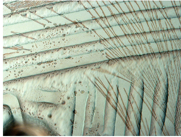
Figure 6.6 – Aspect d’une partie du wafer après l’électrodéposition d’environ 45\ \mu\text{m} de cuivre
