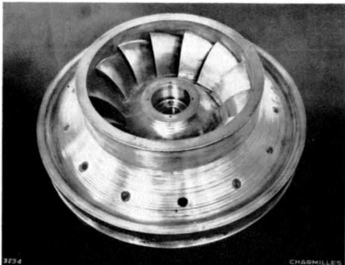
Fig. 22. — Vue de la roue d'essai exécutée suivant le tracé I
