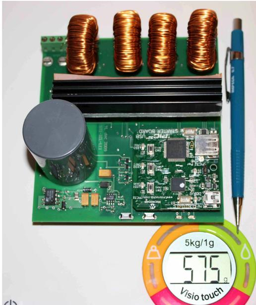
**FIGURE 6.6.** Poids total du convertisseur à 4 canaux de 2kW
